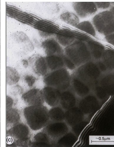
Précipités \text{Ni}_3\text{Al} (10-100 nm)
